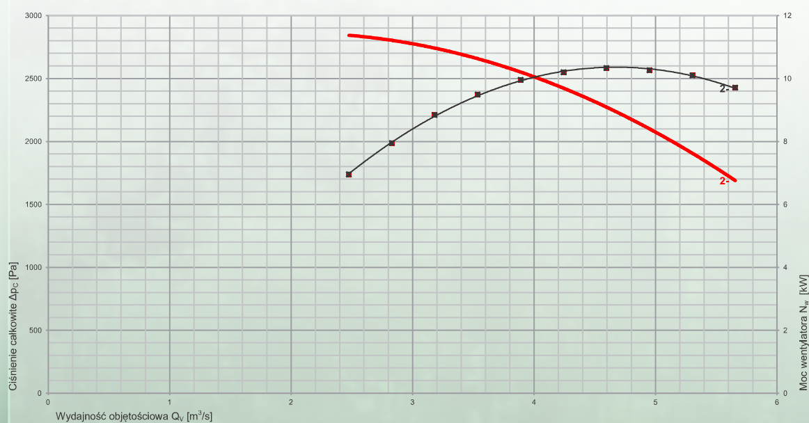
CHARAKTRYSTYKA PRZEPŁYWOWA WENTYLATORA PROMIENIOWEGO WPMS-45/1,8 – 2SIE160L4 / 15kW / 1470obr -1
