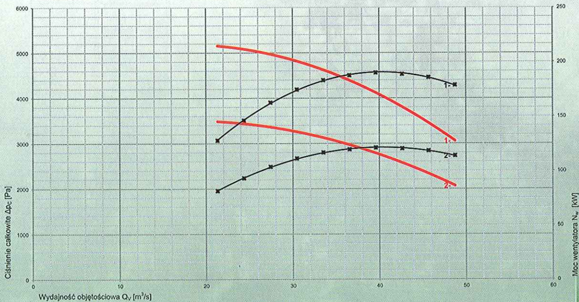
CHARAKTERYSTYKA PRZEPLYWOWA WENTYLATORA PROMIENIOWEGO WPMDs-90/1,8 - 2SIE355ML6B / 250kW / 990obr -1
