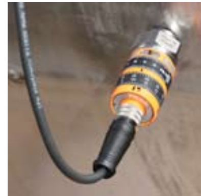
Pozycja czujnika na obudowie wentylatora (A2 : VKV 021)
