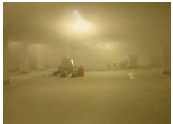
Test z ciepłym dymem podczas uruchomienia instalacji
