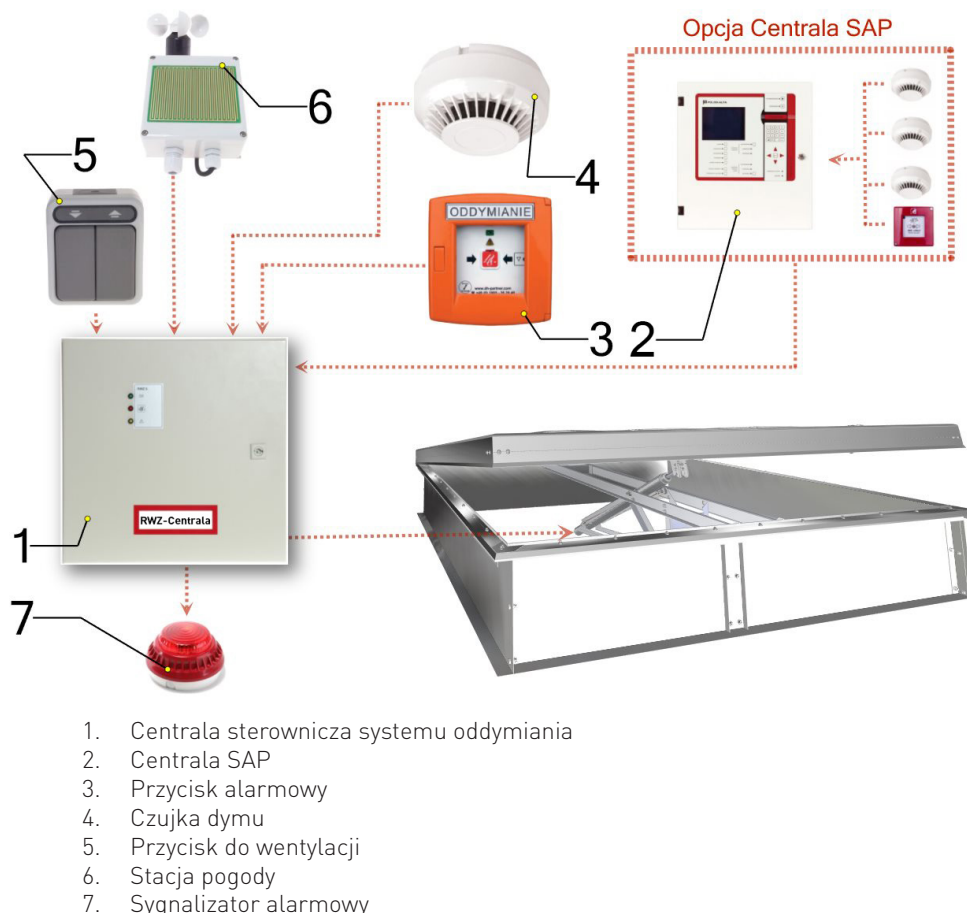
Rysunek 22. Kłapa typ „B”, z siłownikiem elektrycznym, centralą sterowniczą i centralą pogodową. Otwieranie ręczne lub automatyczne po przekroczeniu temperatury lub sygnałem z SAP (z modułem elektrycznym). Wentylacja siłownikiem elektrycznym.
