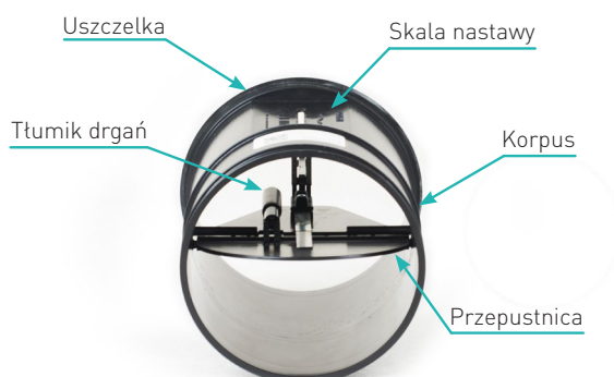
Rysunek 2. Budowa regulatora KCR-R.
