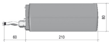
Rysunek 2. Wymiary siłownika ExMax 5.10-BF
