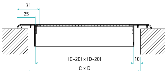
Rysunek 2. Wymiary kratki AL-ST.
