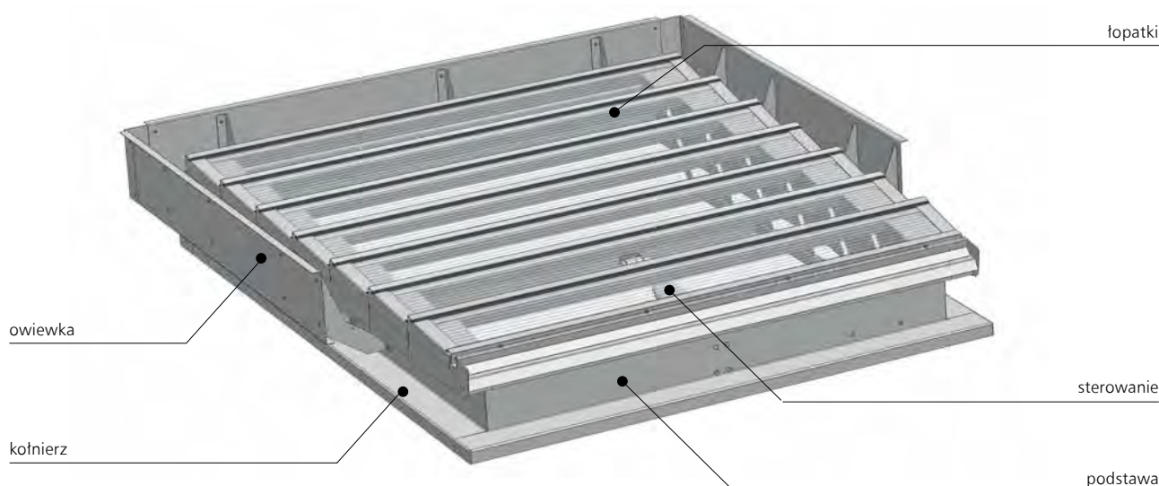
Rys. 172 – Budowa klapy żaluzjowej oddymiającej mcr LAM
