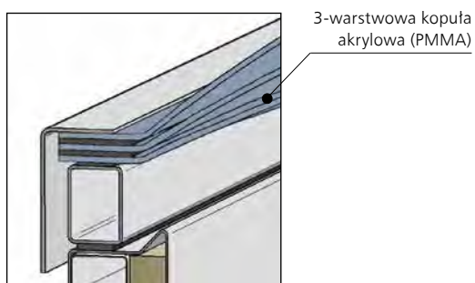
Rys. 48 – Wypełnienie kłapy – 3-warstwowa kopuła akrylowa
