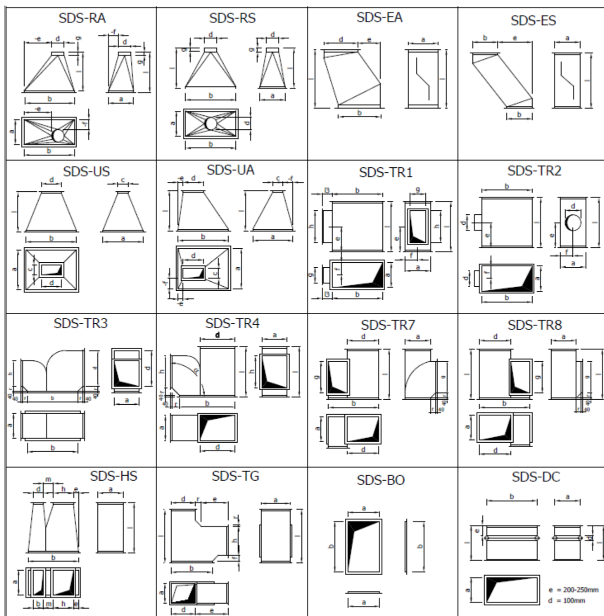
Rys. 1. Zasady wymiarowania podstawowych typów elementów przewodowych
