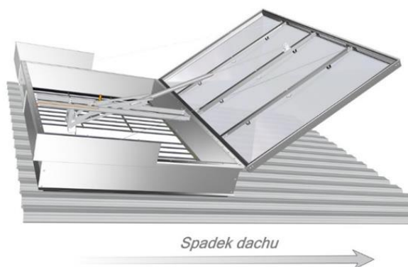
Rysunek 5.48. Montaż kłap SCD-1-L na dachach pochylonych
