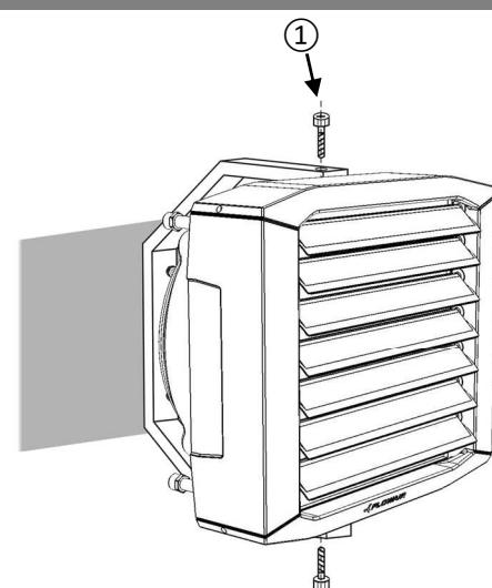
(1) - śruby M8 dołączone w zestawie z konsolą | M8 screws are in set with AGRO bracket | M8-Schrauben sind im Bausatz mit der Konsole enthalten | Винт M8 поставляется в комплекте с консолью
