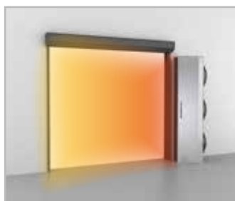
B) Brama otwarta – wentylatory kurtyny pracują na ustawionej prędkości obrotowej.
