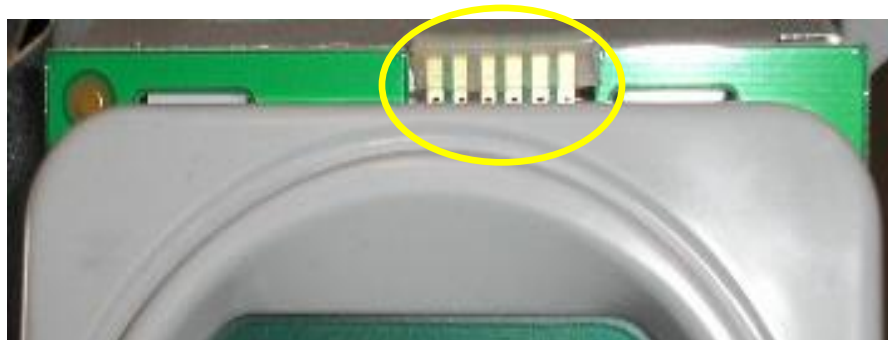
Rysunek 21 – Przycisk reset na termostacie zabezpieczającym
